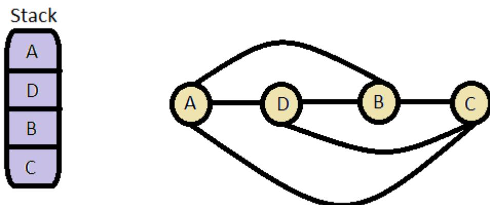
Estraendo elemento per elemento dallo stack, tramite operazioni di pop, vi è la possibilità di controllare ( in base all'ordine topologico ) i nodi "target" provenienti da quello appena estratto verificandone e salvandone la distanza ed elevazione.
