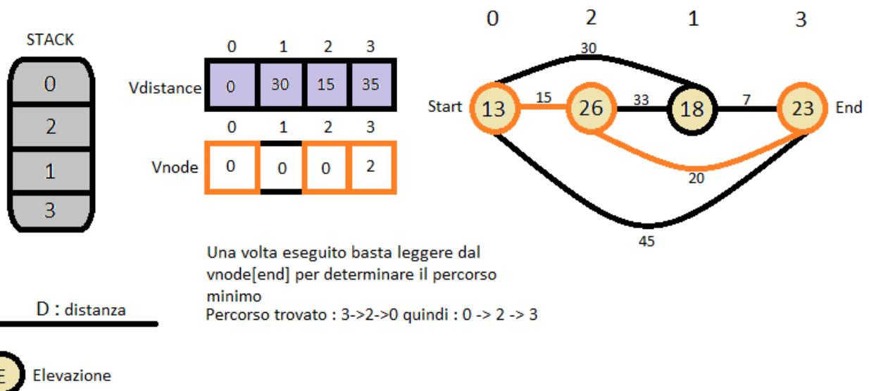
Una volta eseguito lo shortest path leggendo il vettore Vnode dall'end è possibile estrapolare il percorso trovato.
